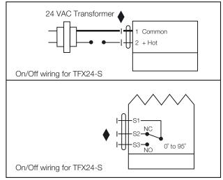
Fig. 2 24 VAC/VDC Actuator
